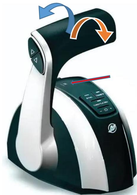
Là aussi, contrairement aux manettes mécaniques où il est nécessaire d'actionner un bouton sous la poignée pour quitter le point mort vers la position « marche avant » ou « marche arrière », les **manettes électroniques ou numériques sont dépourvus de système de blocage**. Ainsi un **simple cliquet** est à passer pour enclencher la propulsion et un **voyant « Neutral »** indique s'il on est au point mort au non.
