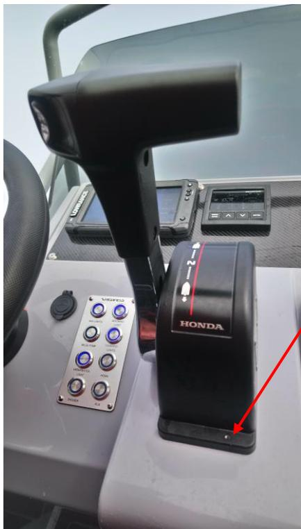
Contrairement aux manettes mécaniques où il est nécessaire d'actionner un bouton sous la poignée pour quitter le point mort, ici il suffit simplement de basculer la poignée vers l'avant ou l'arrière pour enclencher la vitesse.
